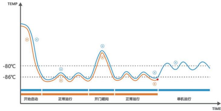
单系统出现故障，另一个系统仍能维持箱内温度在-80°C稳定运行，全面保障样本安全
